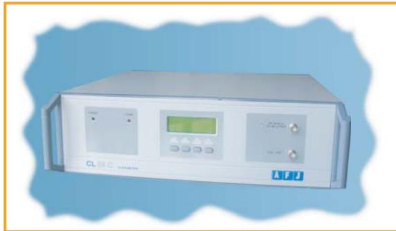
“喀呖声”具有明显超过稳态干扰的强度但是持续时间非常短的特征，所以CISPR14-1专门制定了针对此类产品的干扰测试标准，所引用的标准为IEC 61000-6-3中关于住宅及照明限值标准以及IEC 61000-6-4中工业标准，同样也参考了EN55103中关于个人音视频产品的标准。
