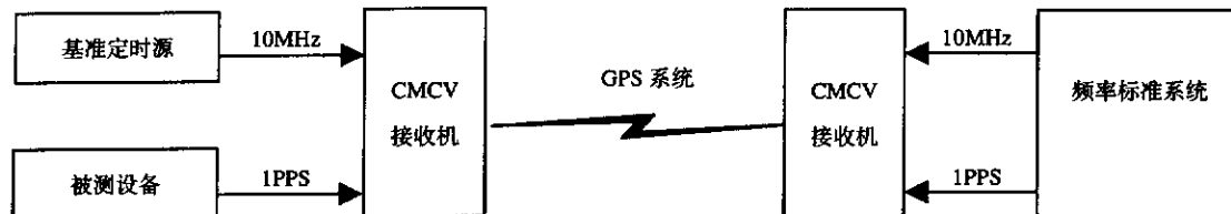
图6 频率准确度测试连接示意
